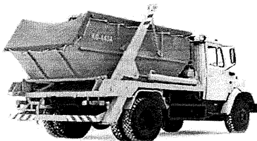
Рисунок – 19 Вид бункера закрепленного на бункеровозе КО – 440А
