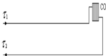
Рисунок 25 – Схема присоединения теплопотребляющих установок потребителей к тепловым сетям
